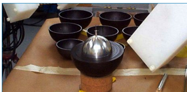
Figura 1. Esfera de neptunio revestida de níquel [3]
