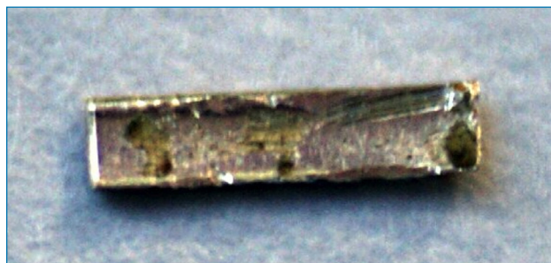
Figura 1. Radio-226 electrodpositado sobre lámina de cobre y recubierto con poliuretano para evitar la oxidación [7]
