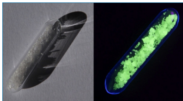
Figura 2. Cristales de sulfato de terbio(III) (izda.) y su emisión verde bajo iluminación de luz UV (dcha.) [5]
