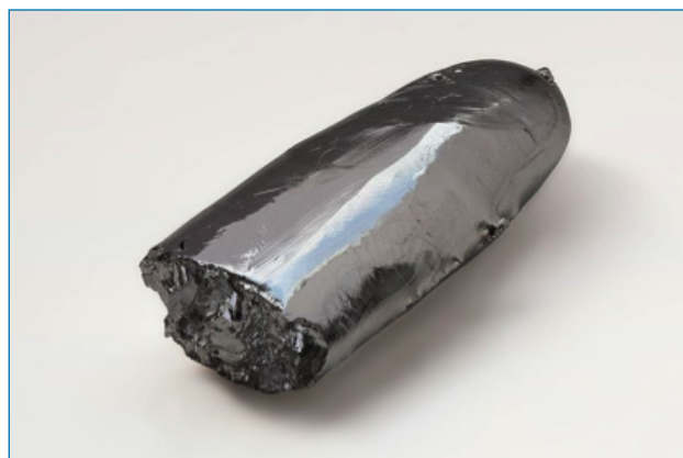
Figura 1. Barra de rutenio de alta pureza (99,99 %) obtenido mediante un procedimiento de fusión con haz de electrones [4]
