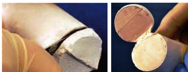
Figura 1. Corte de una barra de sodio (izda.) y su aspecto recién cortada [4]
